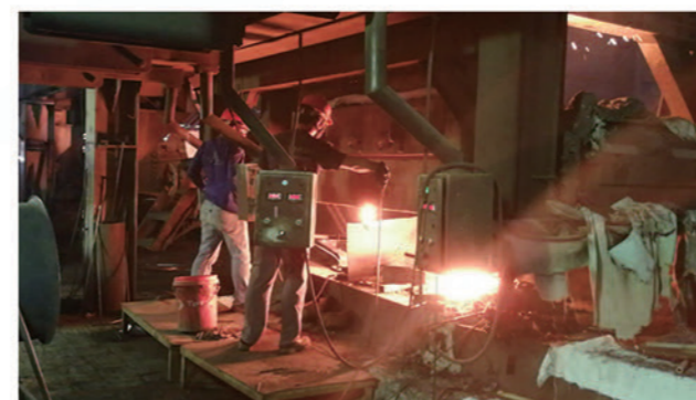
P3控制箱-连铸机拉速控制 P3 Control Box-CCM Flow Speed Control
