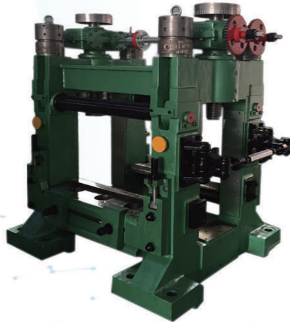
二棍液压锁紧上调整轧机 3-Hi Roller-Hydraulic Lock Upper Regulation
